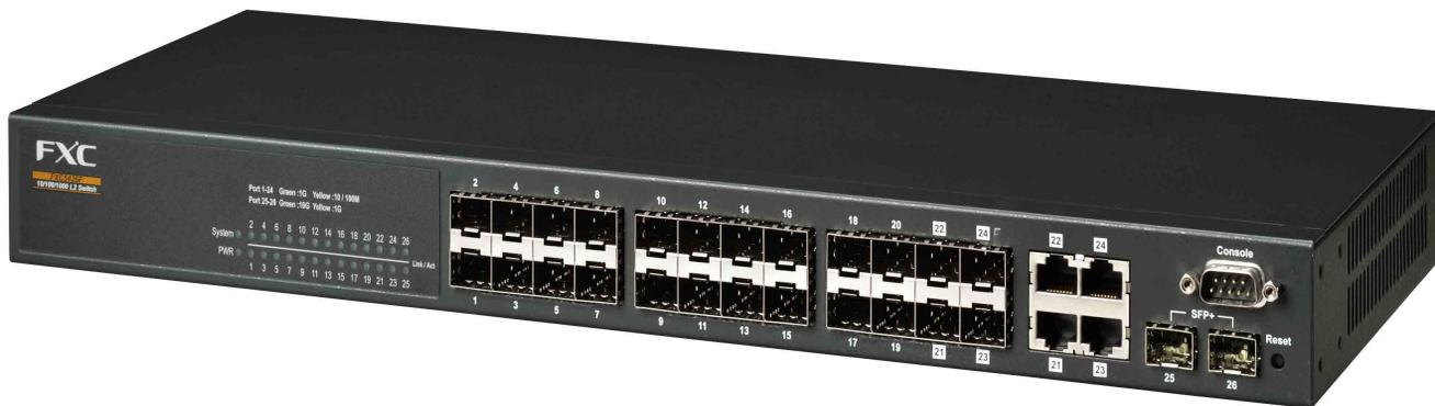
FXC5426Fは24ポートの100/1000Mbps SFPスロットを搭載し、SFPの実装によってRJ45及び光モジュールでの収容を可能にします。
